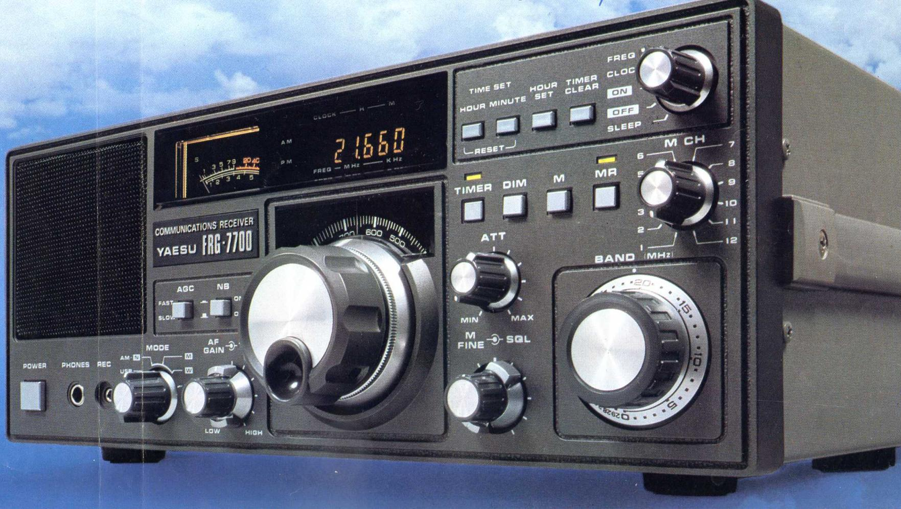
Le FRG-7700 est un récepteur très sophistiqué destiné aux amateurs d'ondes courtes les plus exigeants. Construit autour d'un synthétiseur de fréquences, le FRG-7700 permet la réception dans la gamme 150 kHz - 29,99 MHz en tous modes: AM, BLU, CW, FM. En AM, on dispose de 3 largeurs de bande, ce qui permet de sélectionner pour la F.I. la largeur de bande la plus appropriée pour une écoute confortable, même en cas d'interférences.
