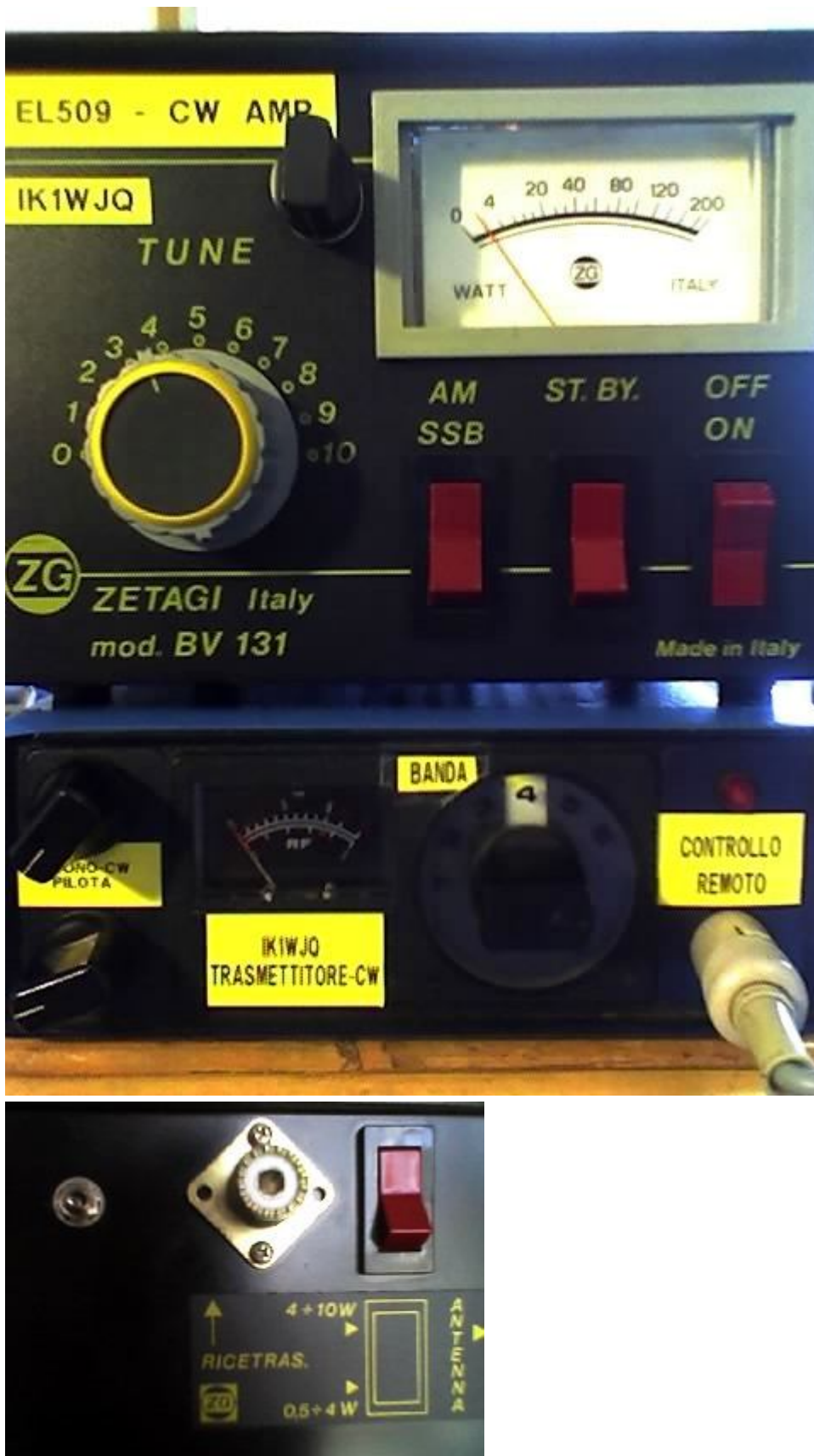
Et le commutateur de relais ajouté sur le côté opposé
